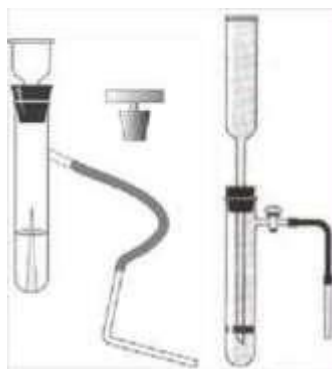
Рис. 7. Прибор для получения и собирания газов
